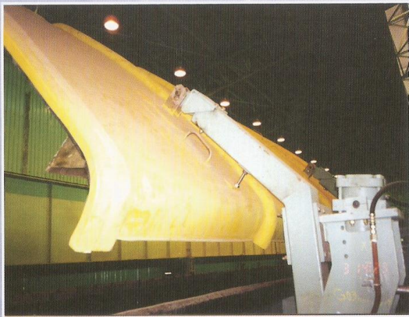
Tampas em PRFV para Tanques de Decapagem. Siderurgia (Laminação de Tiras a Frio)
